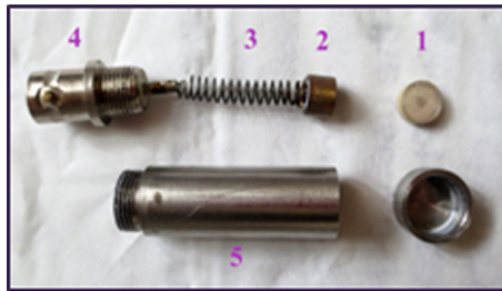
FIGURA 1. Fotografía de las partes del sensor piezoeléctrico utilizado: 1. cilindro piezoeléctrico, 2. cilindro de plomo soldado a un disco de cobre, 3. resorte, 4. conector BNC, 5. carcasa de acero inoxidable.
