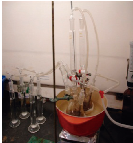
Figura 2. Montaje para la determinación de sulfuros en lodo. Izquierda, montaje sugerido por la EPA 9030. Derecha, montaje real para el desarrollo de la presente investigación.
