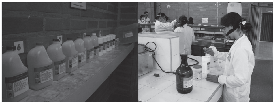
Figura 4. Recipientes rotulados y disposición adecuada de los residuos químicos
