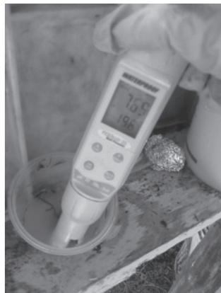
Imagen 3. Medición de pH en pilas
