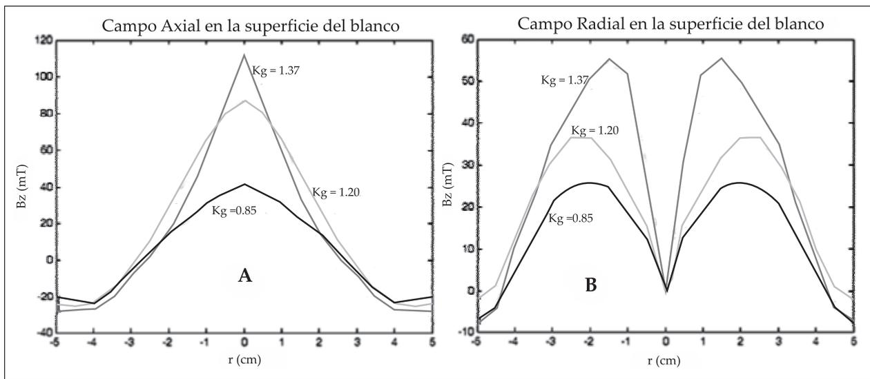
Figura 6. Componentes axial A y radial B en la superficie del blanco con 3 grados de desbalance  $K_G$
