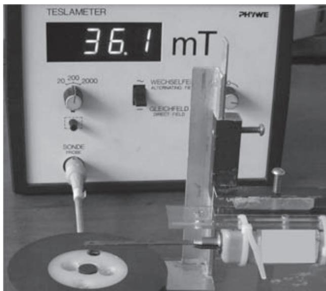
Figura 1. Teslámetro, magnetrón, sonda y montaje para ubicarla y medir  $B_z$  o  $B_r$
