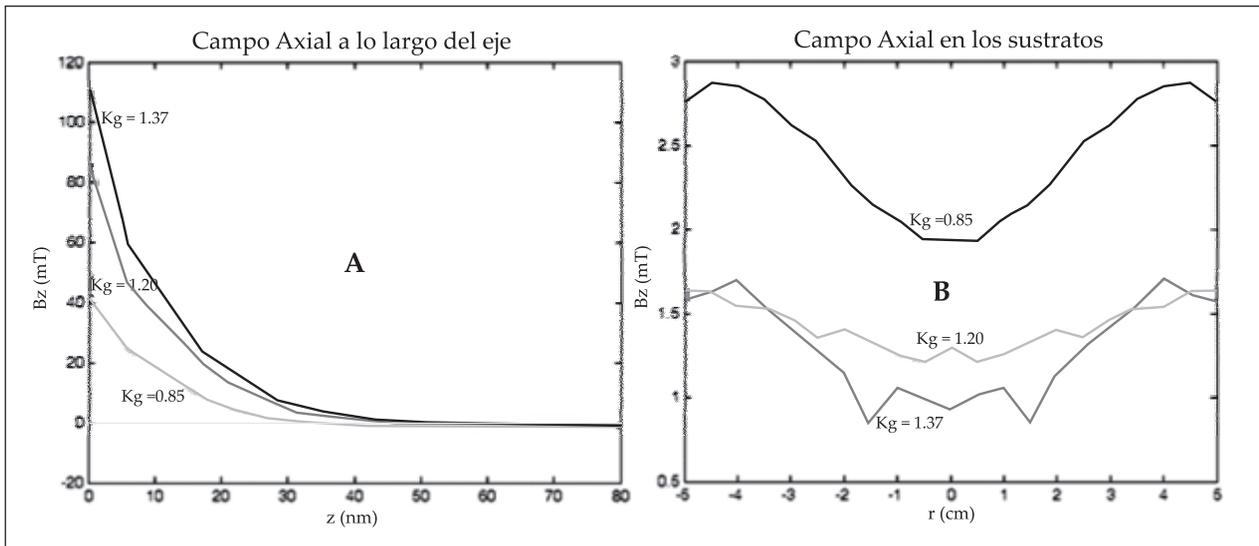
Figura 7. Componente axial a lo largo del eje A y en la posición del sustrato B con 3 grados de desbalance  $K_G$
