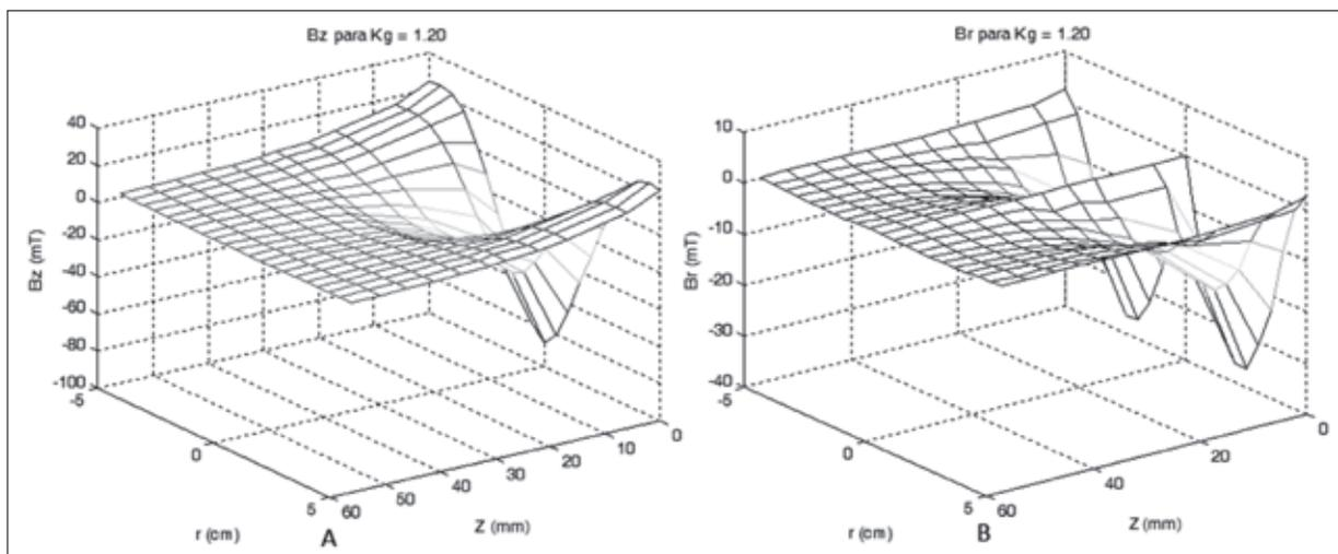
Figura 2. Intensidades de las componentes axial  $B_z$  (figura A), y radial  $B_r$  (figura B) del campo magnético generado por un magnetrón Gencoa VT 100.
