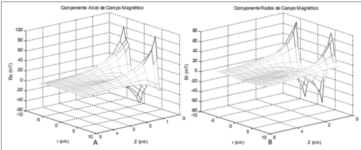
Figura 3. Intensidades de las componentes  $B_z$  y  $B_r$  del campo magnético generado por los imanes de figura 1.
