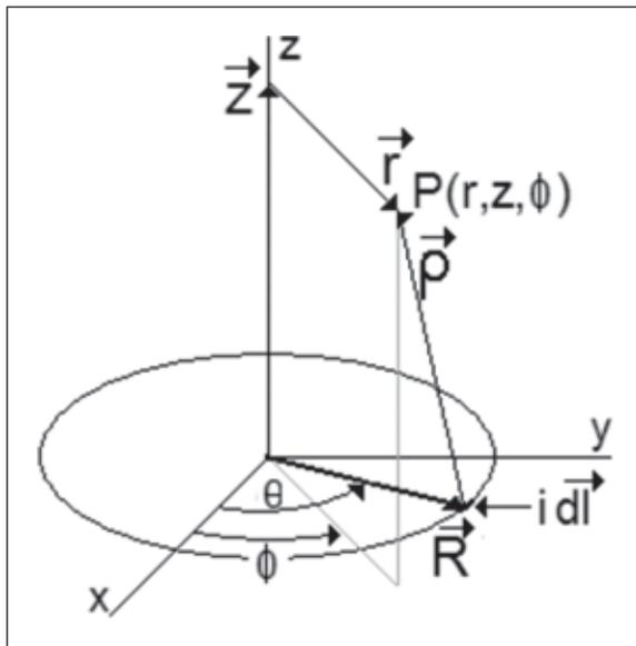
Figura 4. Espira de radio R por la cual circula una corriente i en sentido positivo y coordenadas para el cálculo del campo magnético en el punto P.
