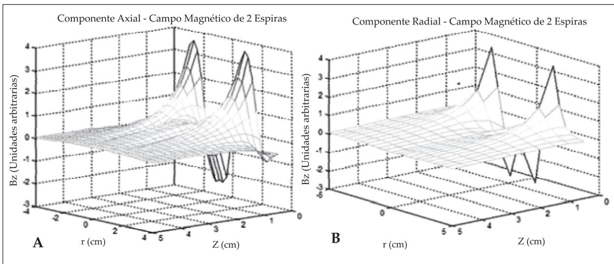
Figura 5. Resta entre las integrales correspondientes a las componentes axiales, (figura A) y radiales (figura B), de los campos magnéticos generados por 2 espiras.
