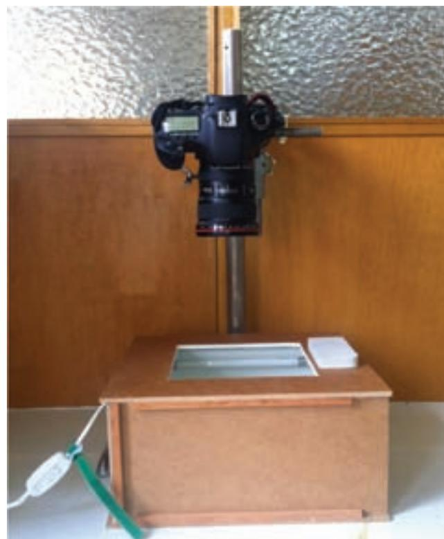
Figura 20. Trípode con cámara fotográfica y caja de Luz.
