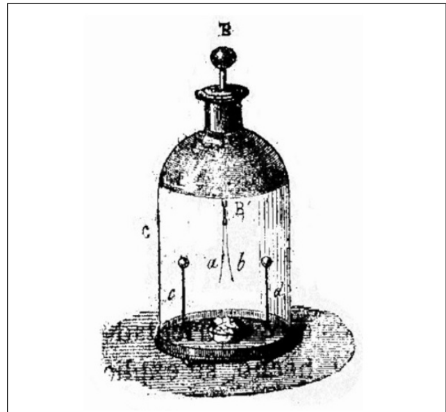
Figura 2. Electroscopio para determinar la naturaleza de la electricidad. Tomado de: http://www.librosmaravillosos.com/laelectricidadysusmaravillas/index.html
