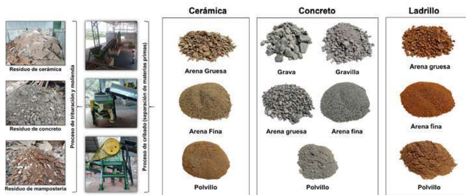
Figura 2. Agregados gruesos y finos obtenidos a partir de RCD
