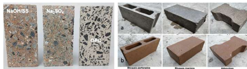
Figura 6. Concretos y elementos prefabricados. a) Elementos a base de OPC; b) elementos a base de concretos activados alcalinamente
