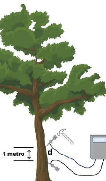
Figura 1. Esquema metodológico de la medición de MOE d en árboles de G. arborea en pie
