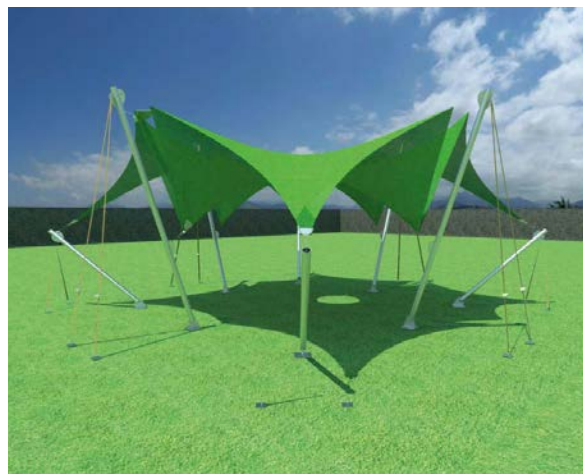
Figuras 36, 37, 38. Diseño de la velaría y render del patronaje del prototipo Fuente: Morales (2014).
