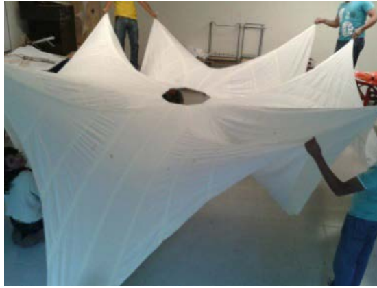
Figuras 29, 30, 31. Manufactura de la velaría del proyecto de investigación Fuente: Morales (2013b).
