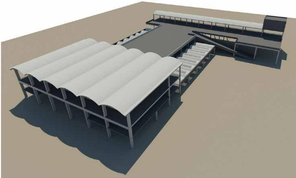
Figura 11. Reconstrucción digital del sistema estructural y de cubierta del edificio
