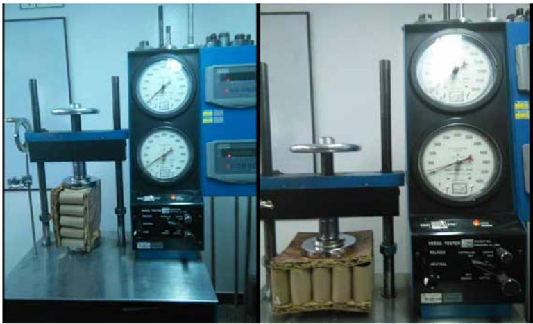
Figura 11. Equipos utilizados (prensa hidráulica) para pruebas de resistencia de carga horizontal y carga vertical
