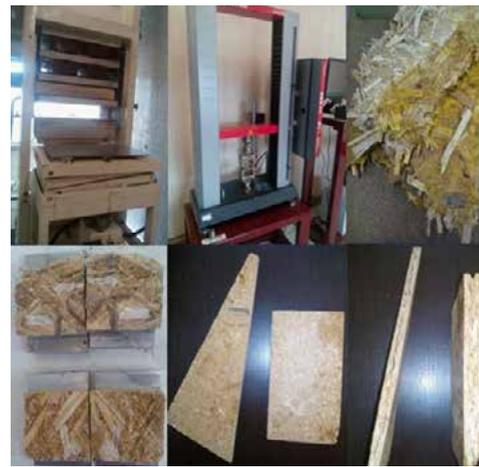
Figura 12. Proceso de fabricación de probetas y tablero
