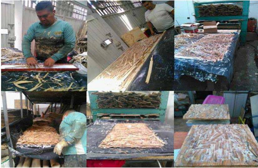
Figura 7. Proceso de fabricación del tablero OSB, empresa Muiskey
