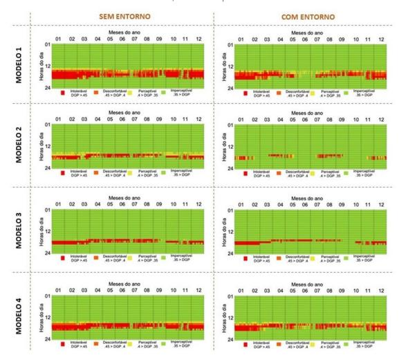
**Figura 10.** Simulação de DGP com comparativo entre os modelos 1, 2, 3 e 4 com e sem a presença de entorno, orientados para Oeste
