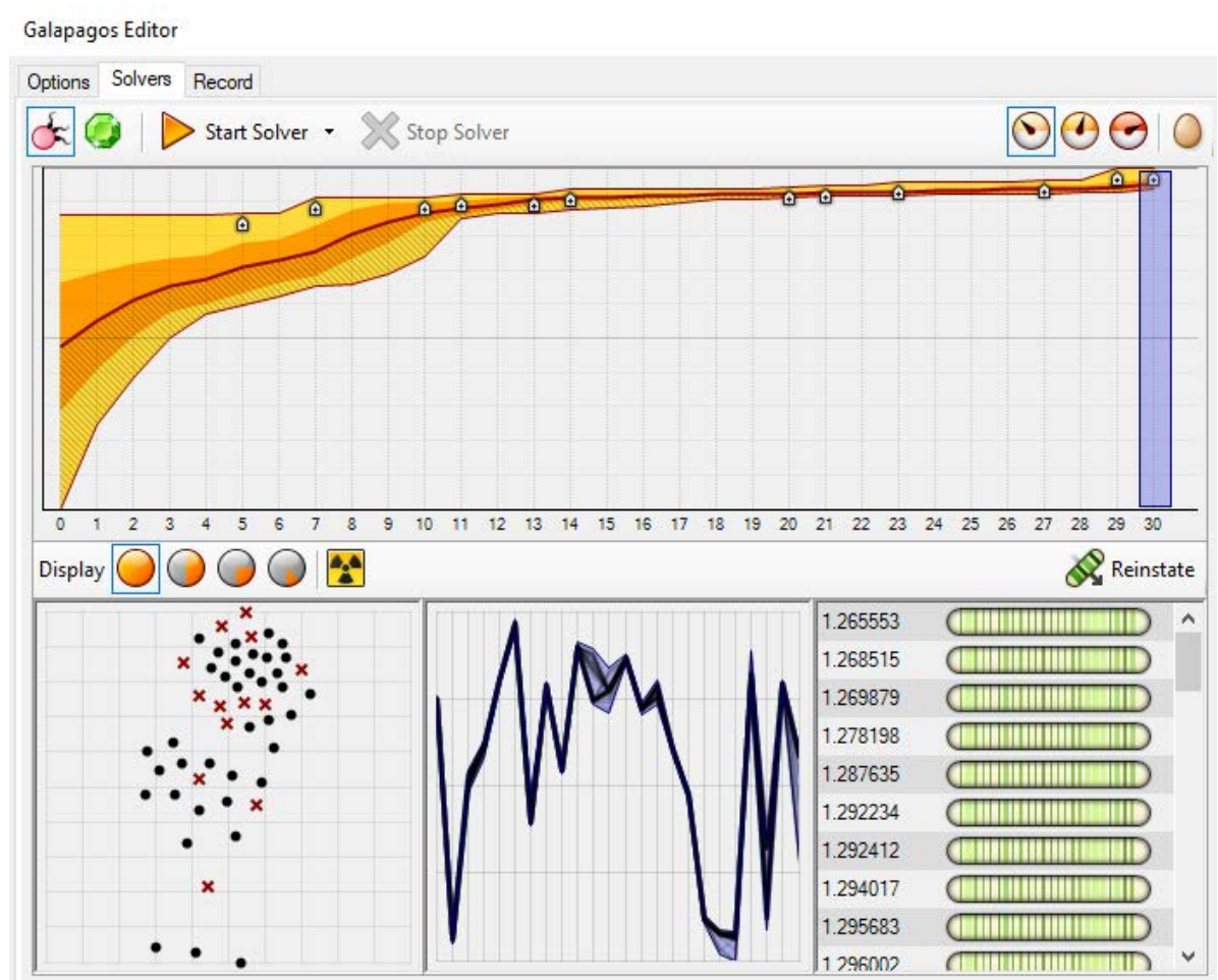
Figura 2. Modelo 1. Visualización de resultados generados por un algoritmo genético para optimizar combinaciones formales y maximizar la eficiencia energética del modelo
