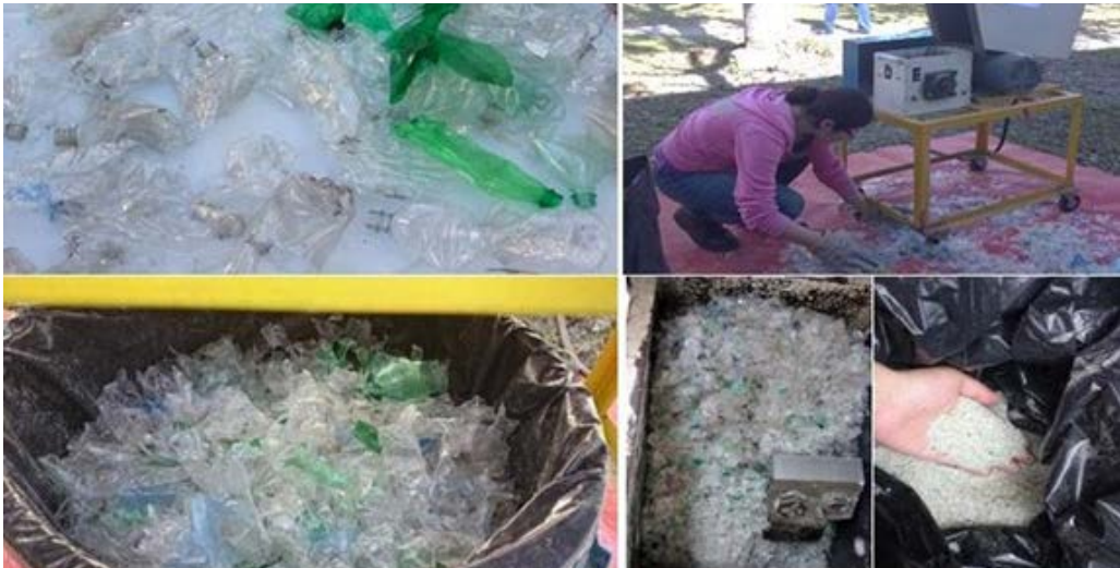
Figura 3. Botellas comprimidas (superior izquierda), trituradora de PET (superior derecha), hojuelas de PET de distintos tamaños
