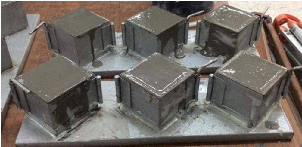
Figura 11. Moldes en reposo a temperatura ambiente, en el laboratorio de Mecánica de Suelos de la Facultad de Ingenierías de la Universidad Veracruzana
