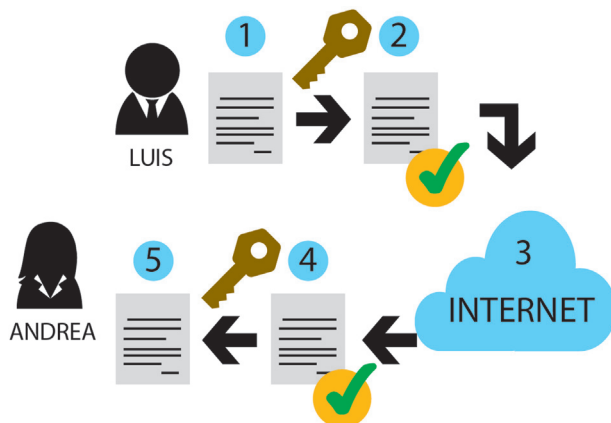
Figura 3. Representación del protocolo de Secure Sockets Layer. Fuente: Autores.
