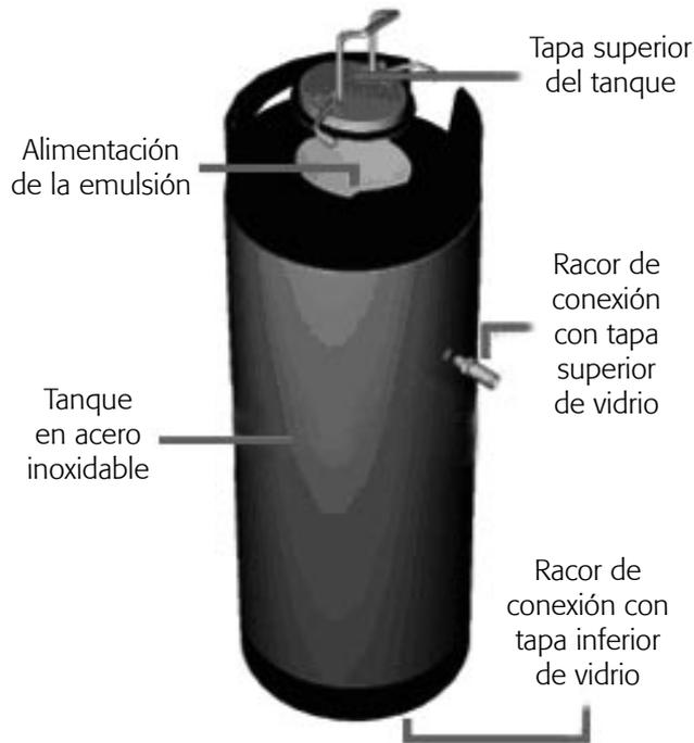
**Figura 7.** Tanque de recirculación.
