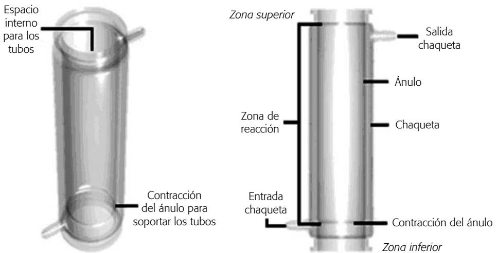
**Figura 3.** Columna de vidrio con chaqueta de la zona de reacción.
