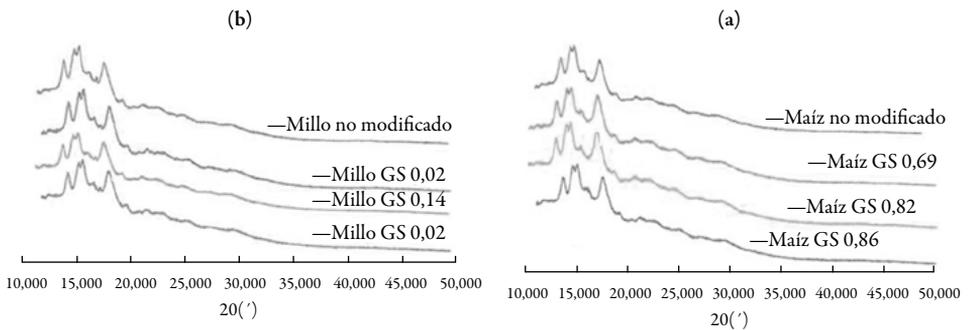
Figura 8. Perfil cristalográfico de los almidones de maíz (a) y millo (b) en estudio mediante DRX.
