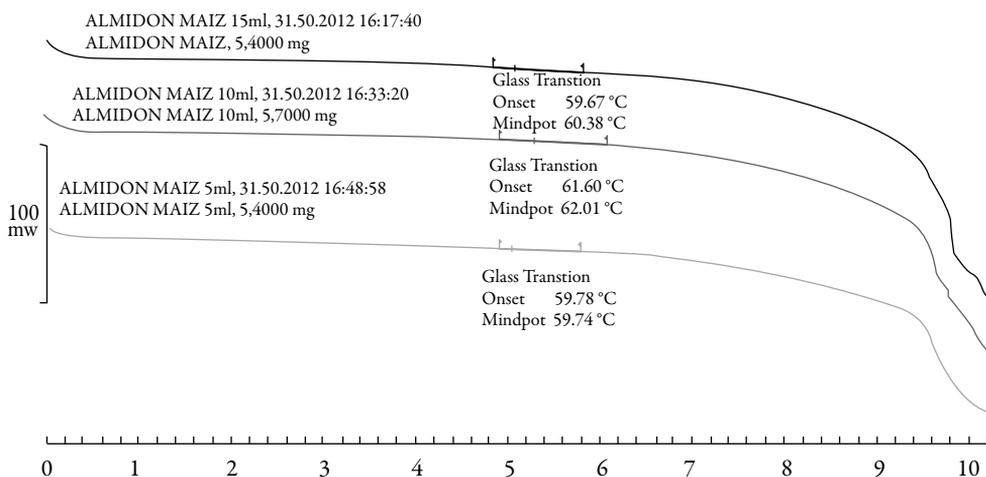
Figura 4. Termograma de los almidones de maíz acetilados. Almidón de maíz 5 mL: nivel I; almidón de maíz 10 mL: nivel II; almidón de maíz 15 mL: nivel III.
