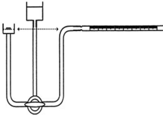
Figura 1. Representación esquemática del aparato de Enslin.
