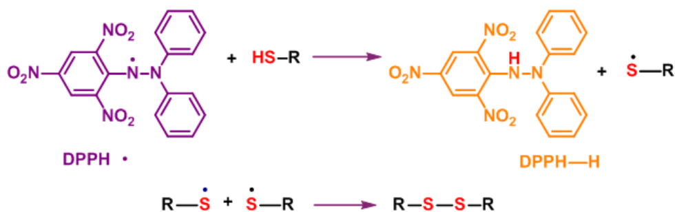
Figura 8. Reacción del mecanismo de eliminación de radicales libres DPPH \cdot mediante el grupo tiol (-SH).
