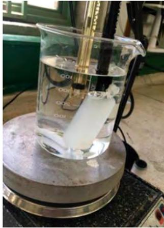
**Figura 1.** Fotografía del montaje del ensayo de liberación empleando bolsa de diálisis.
