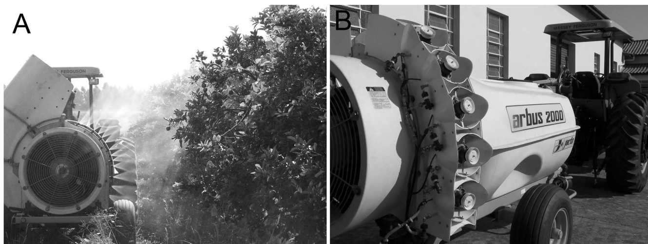
Figura 1. Sistemas de aplicación equipados con puntas hidráulicas A y con atomizadores rotativos de disco B.
