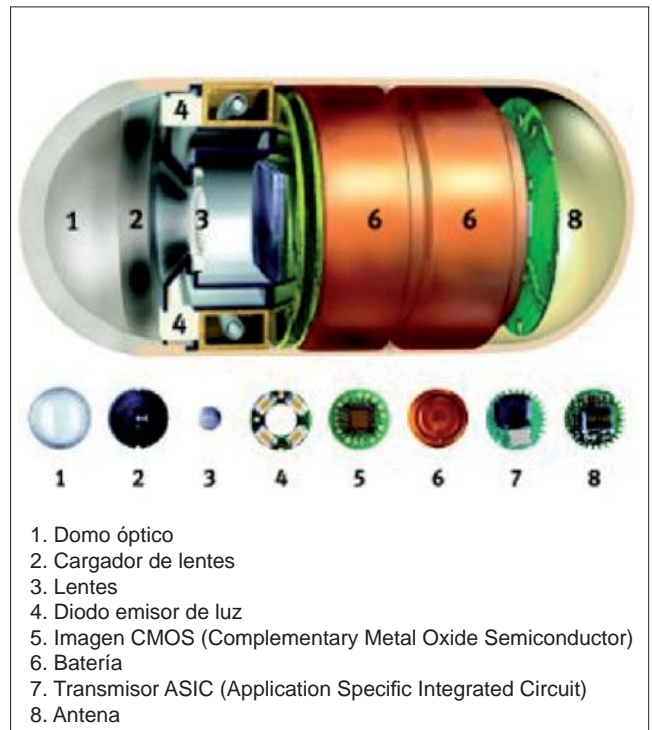
Figura 2. Videocápsula PillCam SB, detalle de sus componentes.
