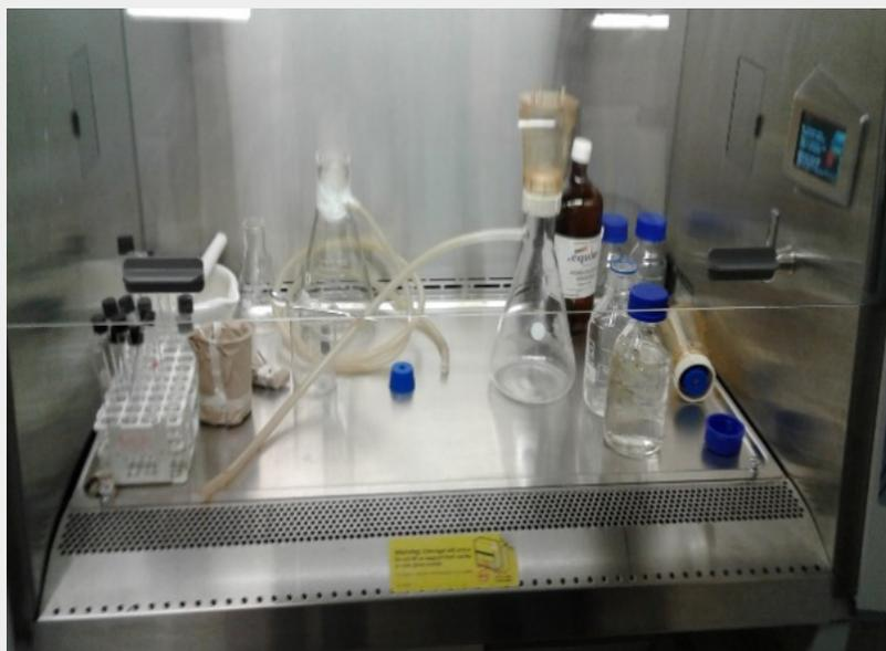
**Figura 1.** Alistamiento de materiales en cabina de flujo laminar: Materiales utilizados en la obtención de los extractos acuosos de canela (*Cinnamomum verum*), posterior al proceso de esterilización a 121 °C, 15 PSI, durante 15 minutos.
