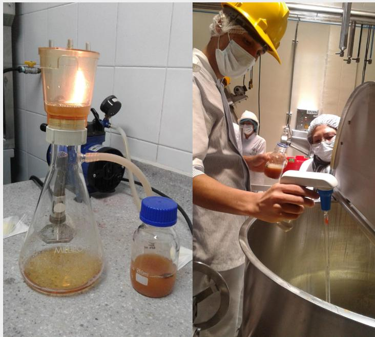
**Figura 4.** Izquierda: Obtención de extractos acuosos de canela. Derecha: Adición de extractos acuosos a tanque mezclador: Proceso de adición de los extractos acuosos a las preparaciones con cada una de las frutas (pera, manzana y durazno).
