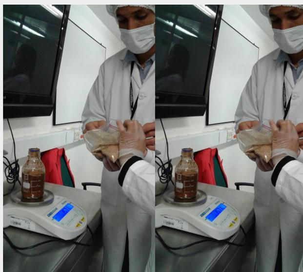
**Figura 2.** Izquierda: Pesaje materia seca de canela. Derecha: Filtrado de la solución acuosa. Método de preparación para los extractos acuosos de canela (*Cinnamomum verum*). A la izquierda se observa el pesaje de la materia seca de canela en la balanza de precisión y en la derecha el filtrado final de la solución, a través de una membrana de celulosa con diámetro de poro de 0,45  $\mu\text{m}$ , para extraer las partículas con diámetro superior a 0,45  $\mu\text{m}$ .
