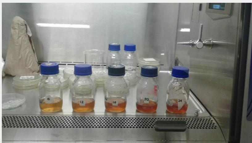
**Figura 7.** Preparación de los extractos acuosos de canela: Preparación de los extractos acuosos de canela (*Cinnamomum verum*) en concentraciones de 8, 12, 16, 20 y 24 gramos por 100 mL.
