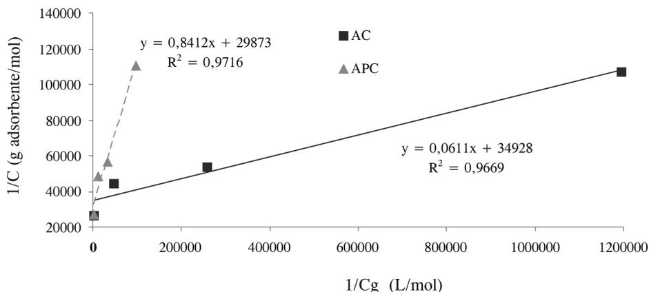
Figura 1. Isotermas de adsorción de Langmuir AM en aserrín AC y APC.
