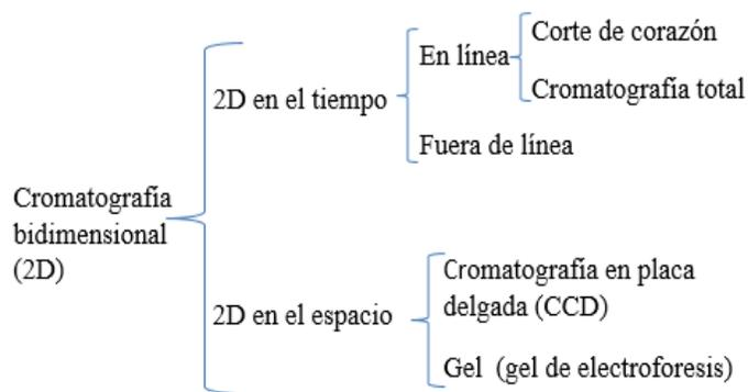
Figura 1. Clasificación de la cromatografía bidimensional
