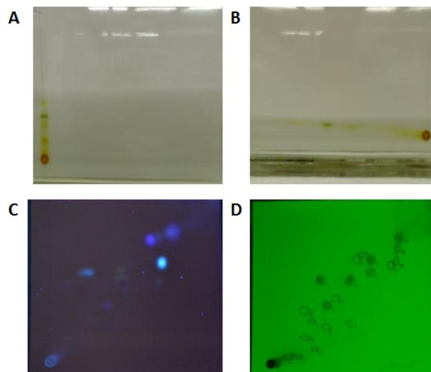
Figura 2. Proceso (CCD-2D) de los extractos etanólicos de corteza y hojas de Lauraceae. **A** Desarrollo en la primera dimensión. **B** Desarrollo en la segunda dimensión. **C** Fluorescencia observada a 254 nm. **D** Placa con marcas de las manchas observadas a 254 y 366 nm y vapores de  $I_2$
