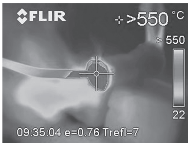
Figura 8. Prototipos Sometidos a la prueba de llama Fuente: elaboración propia
