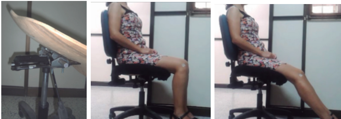
Figura 2. Mecanismo utilizado en las sillas CB y cambio postural obtenido
