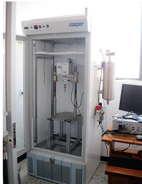
Fig. 3. Equipo Nottingham Asphalt Tester NAT
