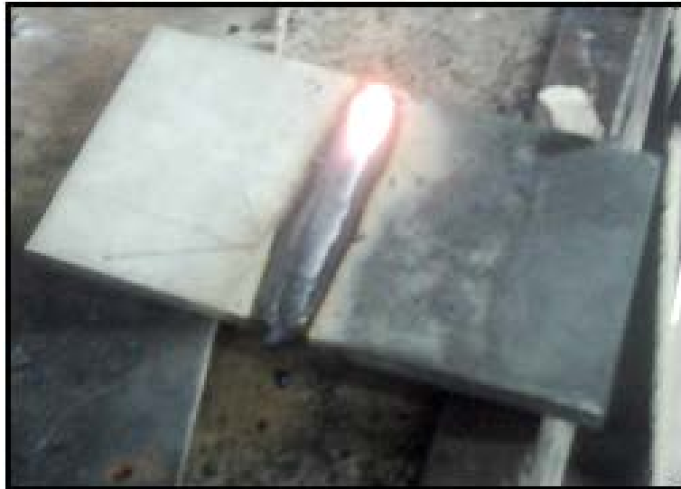
FIG. 2. Unión soldada de un acero inoxidable con un acero de medio carbono depositado por el proceso SMAW
