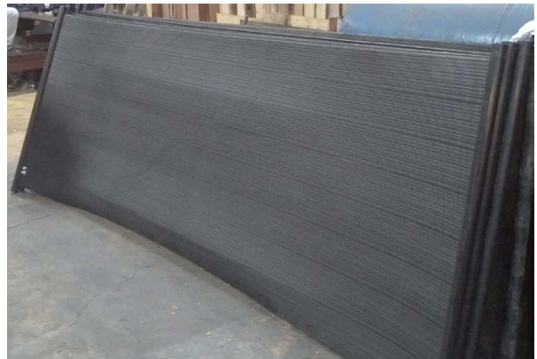
FIG. 1. Colector de placa plana sin cubierta
