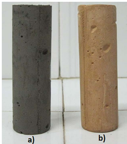
FIG. 1. Imagen digital de probeta compactada de ceniza volante, a) sin tratamiento térmico, b) sinterizada a 1300 °C.
