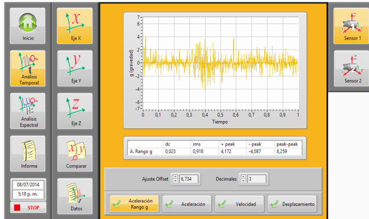
FIG. 12. Interfaz de usuario del sistema de análisis temporal y espectral para la detección de fallas por vibración
