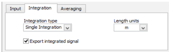
FIG. 9. Configuración del bloque VibrationLevel de LabVIEW para la integración de datos
