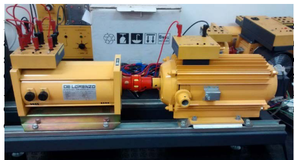
FIG. 3. Planta para toma de medidas de aceleración para la detección de fallas por vibración
