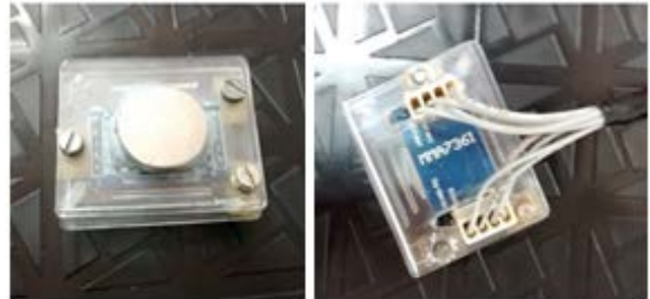
FIG. 5. Estructura de los sensores para medir vibraciones en diferentes puntos del motor eléctrico
