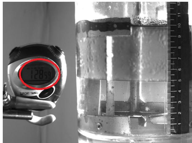
**FIG. 2.** Esquema de la determinación experimental del tiempo de separación de fases.
