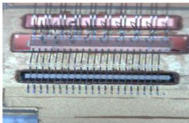
Fig. 2. RFIC: hilos del drenador: parte superior; hilos de la compuerta: parte inferior.
