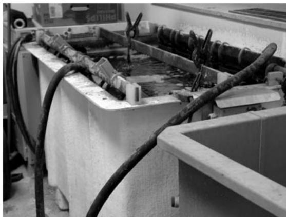
**Figura 5** Baño de cobre ácido
