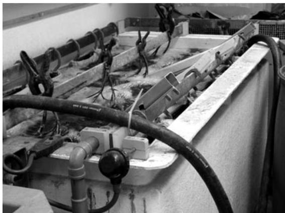
**Figura 4** Baño de níquel sulfatado
