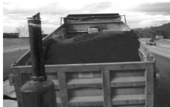
Figura 1 Mezcla asfáltica en el habitáculo de la volqueta [2]
