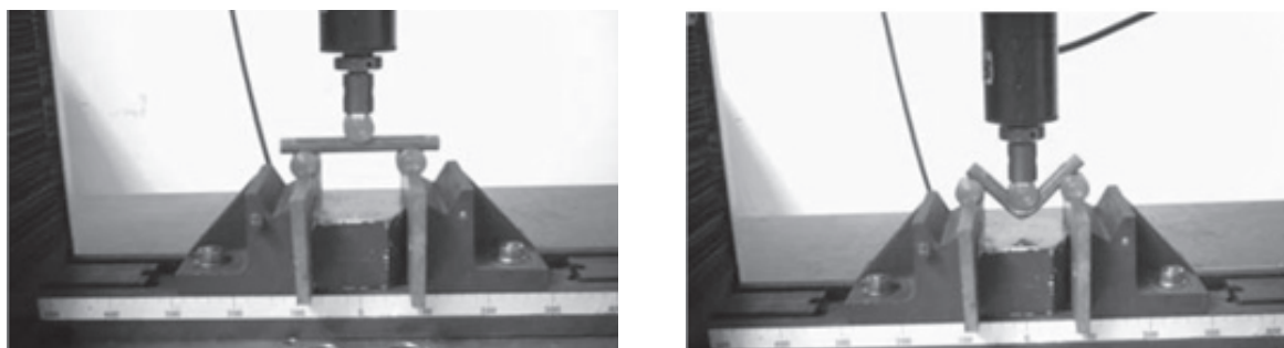
Figura 6 Montaje para ensayos de esfuerzo según norma ASTM D4475-85
