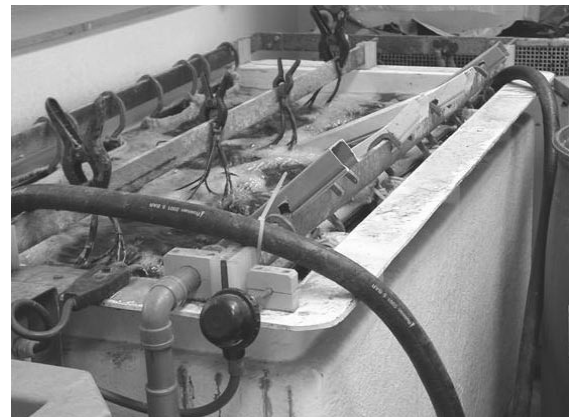
Figura 5 Baño de níquel sulfatado
