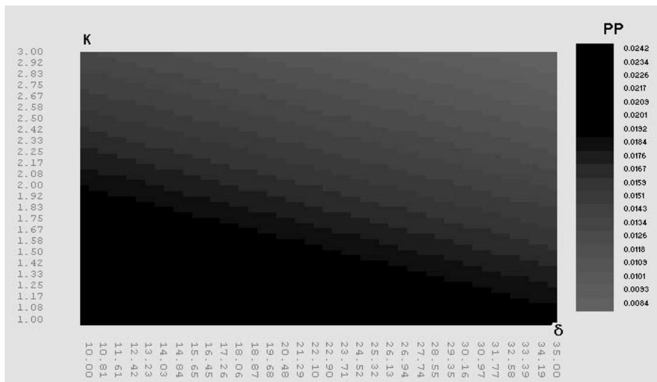
**Figura 4** Gráfico del comportamiento del desgaste abrasivo gravimétrico, respecto a las variables  $\delta$  y  $k$
