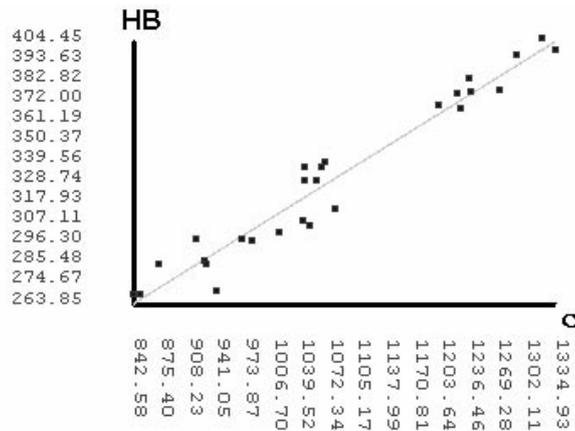
**Figura 3** Gráfico del comportamiento de la macrodureza, respecto a la tensión
