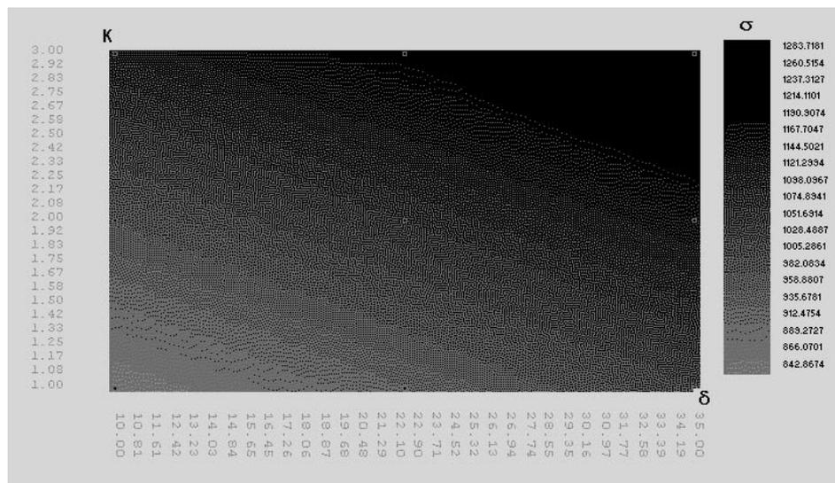
Figura 1 Gráfico del comportamiento de la tensión principal normal de primer género, respecto a las variables  $\delta$  y  $k$
