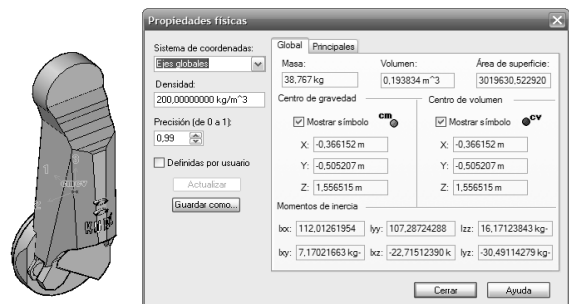
Figura 8 Inercias obtenidas en Solid Edge
