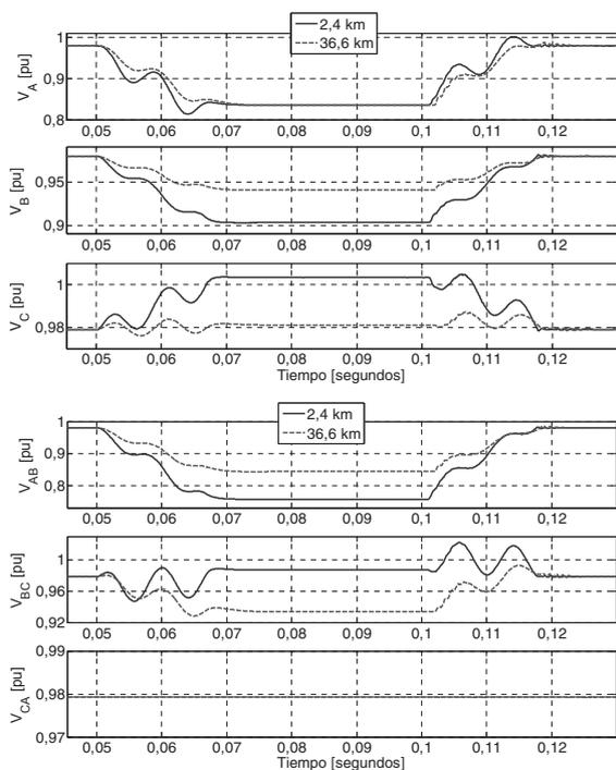
**Figura 3** Comportamiento de las tensiones de fase y de línea ante una falla monofásica en la fase A en dos lugares distintos
