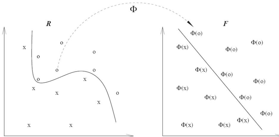
**Figura 2** La SVM no lineal mapea el espacio de entrada en otro de representación de dimensión alta y luego construye un OSH sobre este último, cuya representación en el espacio de entrada es una función de separación no lineal
