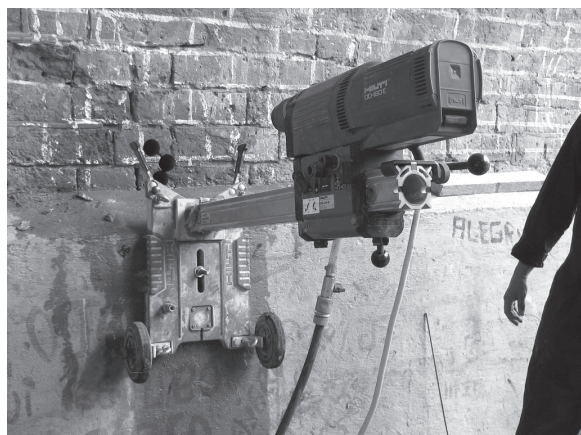
Figura 2 A) Proceso de extracción de núcleos de la mampostería de las bóvedas del puente, B) Especímenes cortados a partir de las muestras extraídas de la mampostería del puente
