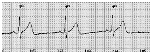
**Figura 12** Señal ECG filtrada usando filtro de Lynn de 48 Hz
