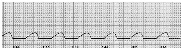
**Figura 8** Señal senoidal adquirida usando el módulo de conversión A/D
