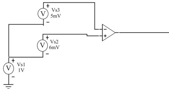
**Figura 5** Potenciales de interferencia en cuantificación bipolar
