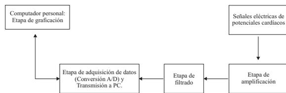
**Figura 4** Diagrama de bloques sistema electrocardiográfico digital
