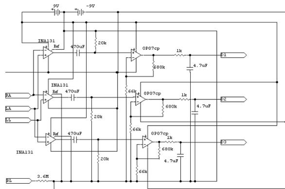
Figura 6 Circuito módulo amplificación de la señal ECG
