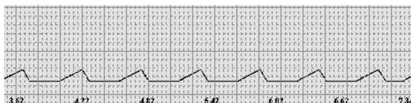
**Figura 9** Señal cuadrada adquirida usando el módulo de conversión A/D
