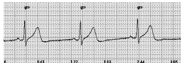
**Figura 11** Señal ECG filtrada usando filtro de Lynn de 35 Hz
