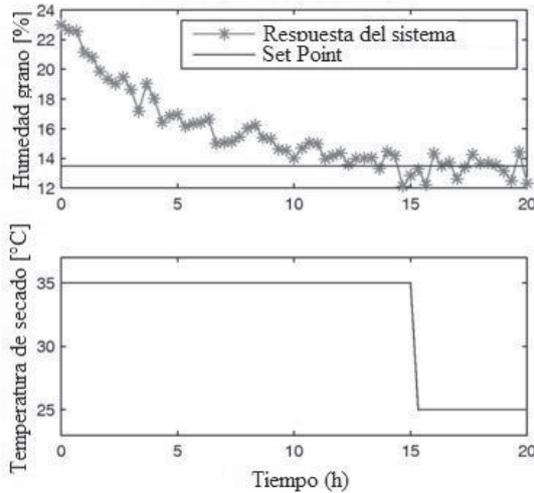
Figura 7 Respuesta del sistema ante la aplicación del control ON-OFF
