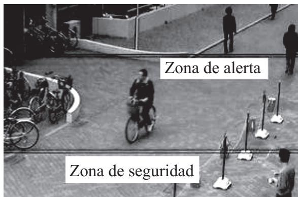
Figura 5 Zonas de seguridad y alerta establecidas con una adecuada posición de la cámara
