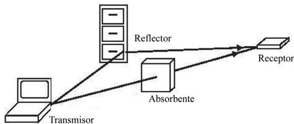
**Figura 6** Modelo de propagación de dos rayos
