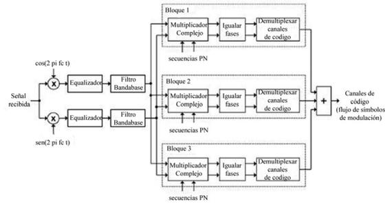
Figura 10 Receptor RAKE de un canal CDMA
