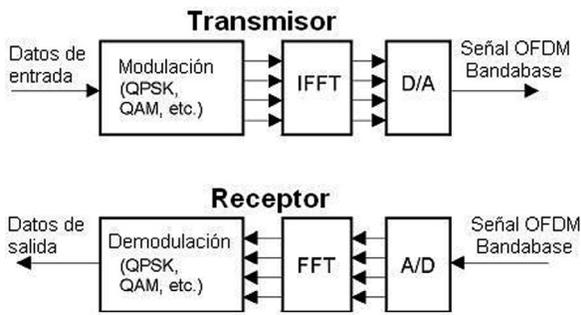
**Figura 13** Sistema de comunicación basado en OFDM
