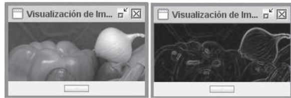
**Figura 13** Operador Sobel aplicado a una imagen en color
