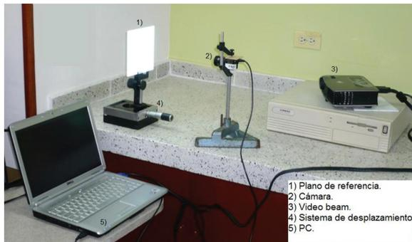
**Figura 3** Modelo experimental implementado
