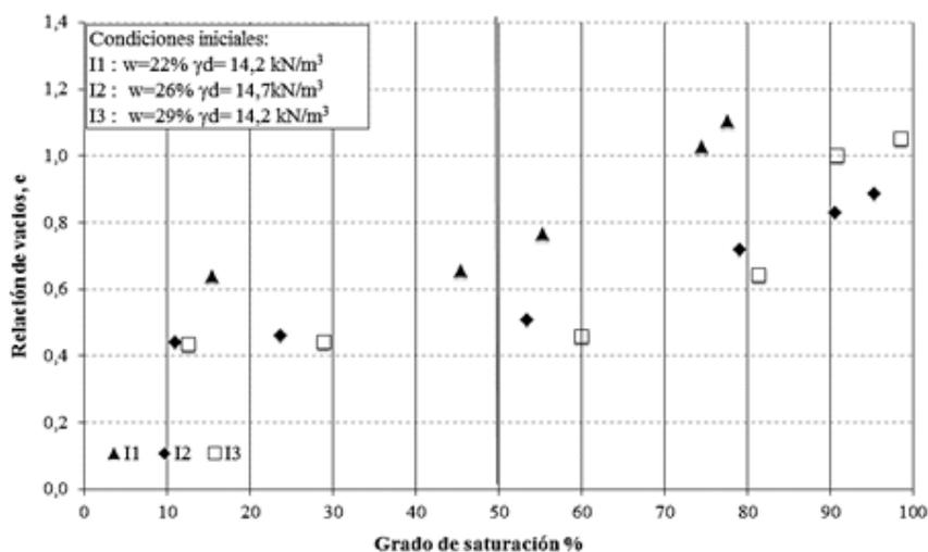
**Figura 8** Variación de la relación de vacíos con el grado de saturación
