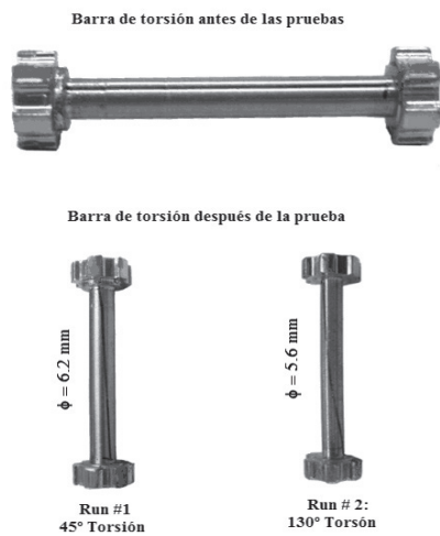
Figura 11 Barras de torsión utilizadas en las pruebas
