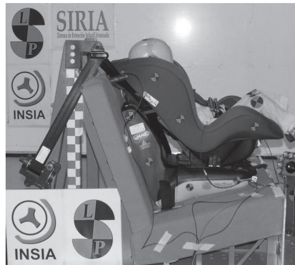
Figura 1 Localización del sistema de retención
